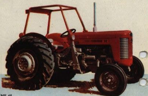
MF 65 Dieselmotor med 50 hk remskiveeffekt. En komplett utrustad traktor.
