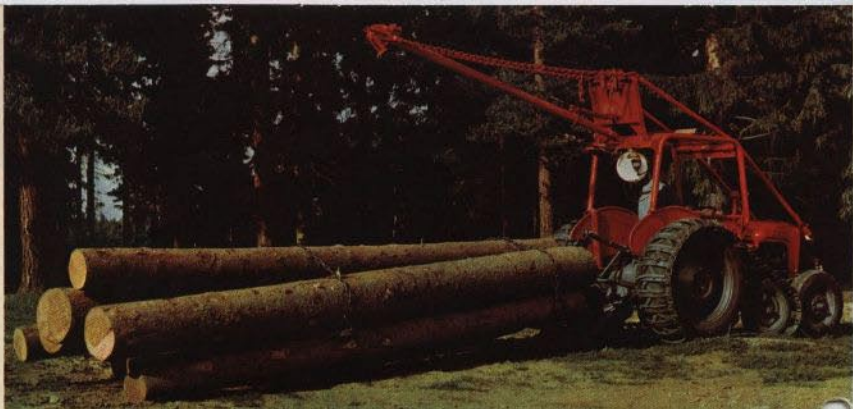
MF 35 med halvband, timmerkälke och timmerkran.
