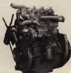
Motor, 3 cyl. diesel eller 4 cyl. bensin, med 38 resp. 35 hk remskiveeffekt.
