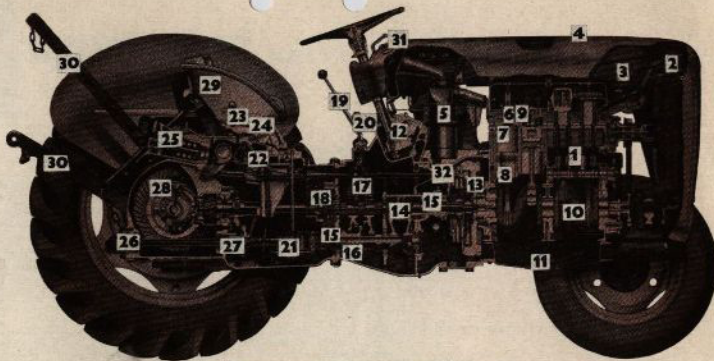
Genomskärning av Ferguson 35 med dieselmotor.
