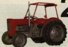
MF 25 — ekonomitraktorn i den lägre prisklassen. Dieselmotor på 28 hk.
