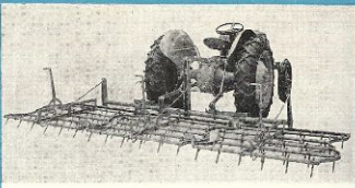
ÅNGSHARY. Tre sektioner, varvid yttersektionerna kunna fällas upp vid transport. Vardera sektionen med 5 axlar och 30 höj- och sänkbara pinnar. Arbetsdjupet och pinnarnas lutning regleras med hävslänger. Höj- och sänkbar till transport och arbetsläge med regleringspaken för hydrauliska systemet. Arbetsbredd: 400 cm. Vikt: 195 kg.
