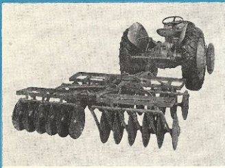
TALLRIKSARY. 4 sektioner med belastningsramar. Varje sektion med 6 tallrikar 18" diameter. Tallrikarnas vinkelställning reglerbar från förarsätet med hjälp av regleringspaken och hydrauliska systemet, varför tallrikarna lätt kunna rakställas vid varje vändning. Arbetsbredd: 180 cm fram, 200 cm bak. Vikt: 290 kg.
