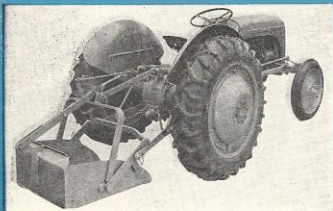
MULLSKOPA. Arbetsbredd: 65 cm. Mullskopans djup 82 cm. Mullskopans höjd längst bak 32 cm. Hög- och sänkbar till transport och arbetsläge med regleringsspaken till hydrauliska systemet. Vikt: 80 kg.
