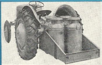
TRANSPORTBOX. Fästs i dragstängemas fästpunkter. Hög- och sänkbar till transport och lastnings- resp. lossningsläge med regleringsspaken för hydrauliska systemet. Längd: 155 cm. Bredd: 77 cm. Lastförmåga: 250 kg. Vikt: 55 kg.
