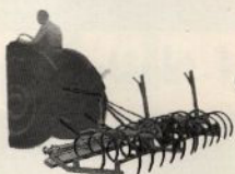
Harvar och kultivatorer för hydraulisk manövrering.
