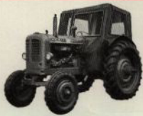
Specialtillverkad traktorhytt av kraftig, krympfri presenning på rörkonstruktion.
