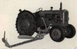
Sidomonterad 6-fots slättermaskin, automatisk utlösning av fingerbalken. Hydrauliskt manövrerad.
