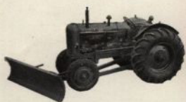
Ställbart skaktblad, hydraulisk manövrerat, arbetsbredd 240 cm.
