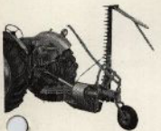
6-fots slåtermaskin av efterhängstyp
