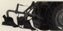
2-skärig 14"-hydraulisk manövr. självutlösande bärplog för mycket styva jordar, efterhängsplog av ordinar typ eller tallriksplog.
