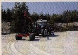
Med hydraulisk vagnstyrning får man vagnen att följa traktorspåren.
