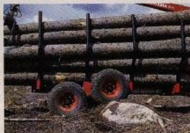
Boggie med stort rörelseschema och för lättare framkomlighet i svår terräng.
