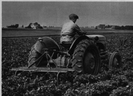
Den lätta traktorn packar inte jorden och är lättmanövrerad i radsådda grödor.
