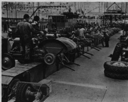
Vid slutet av den långa sammansättningsbanan börjar traktorn ta form och som ett sista tempo monterar hjulen.
