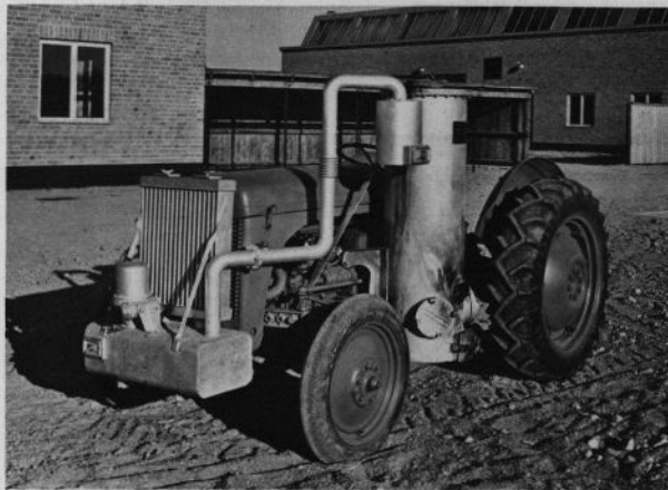
Sedan mer än ett år tillbaka har denna vedgasdrivna Ferguson-traktor undergått omfattande prov vid Statens Maskinprovningar i Ultuna.
