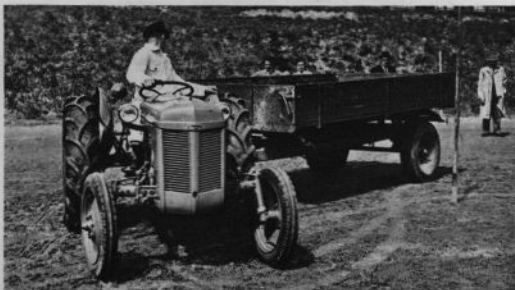
Den enaxliga vagnen med Fergusons koppling utgör tillsammans med traktorn en lättmanövrerad och smidig enhet.
