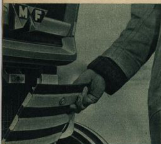
Genom att vrida en spärrskruv plockas en lucka i kylarmaskeringen lätt bort. Kylarellerna blir då lätt tillgängliga för rengöring.
