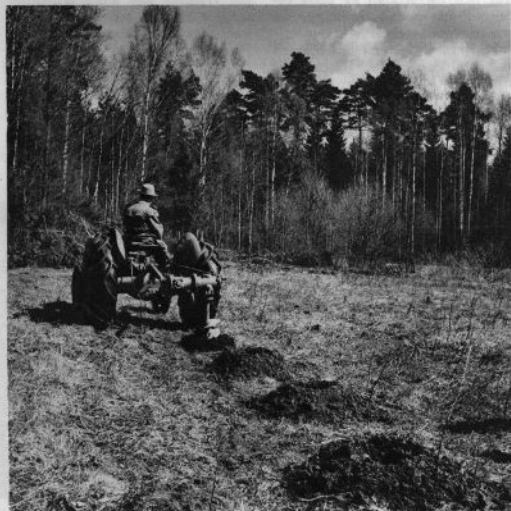
Fergusonstraktorn med jordbort tar på några sekunder upp hål för pålar o. d.-ett av de många anvädningsområden, där hästen aldrig kan konkurrera med traktorn.
