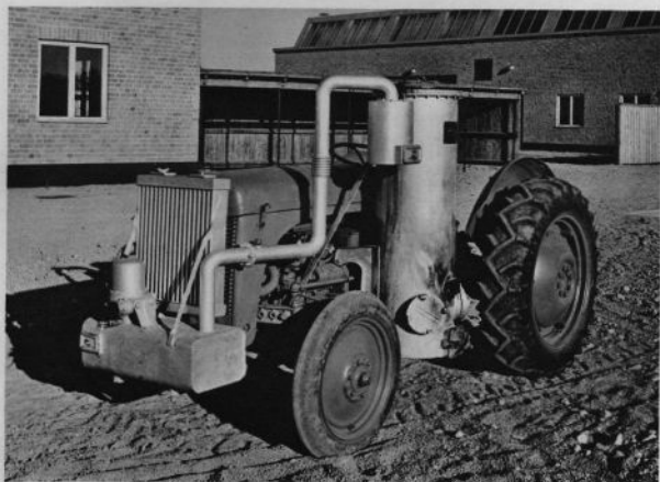
Ferguson med behändig vedgasutrustning.
