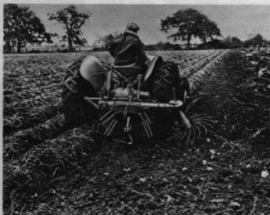
Liksom potatisen kan hackas och kupas med maskinella hjälpmedel, kan den också tagas upp med maskin.
