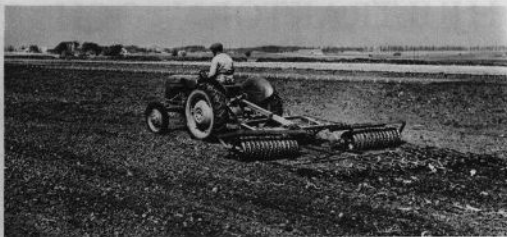
En Ferguson med 3-delad ringvält och harv och en arbetsbredd av 3,75 m gör ett snabbt arbete och är därför bra att ha till bands, när det är bråttom i vårbruket.
