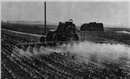
På Evefarm kopplar man ett besprutningsaggregat till traktorn. Här besprutas ett tulpanfält med bourdeauxvätska. Tack vare de stora möjligheterna att variera hjulbredden kan traktorn gå fram utan att skada odlingen. Besprutningsapparaten användes även till fruktträd och potaälsfält.
