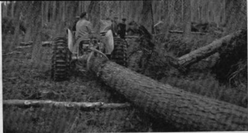
Ungefär två ton vägde denna stock som Ferguson lätt klarade med hjälp av den svenska timmersaxen. Skottarna var också störligen imponerade av prestationen.
