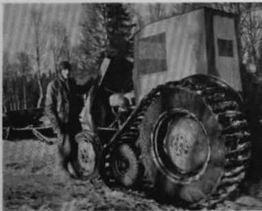
Petrus Gustafsson är lapp, fast han bor i Jämtland, och han har renar. Men han har också en Ferguson. Halvbanden sitter på året om och har hittills fungerat utan några som helst fel.
