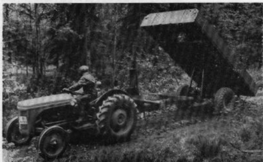
Om detta ekipage yttrade skogsexperterna: För bl. a. gruskörning är ett hydrauliskt manövrerat tippflak på vagnen till stor hjälp. Det behöver inte bli avskräckande dyrt om man som på denna Livavagn utnyttjar tryckoljan från traktorns hydraulik.
