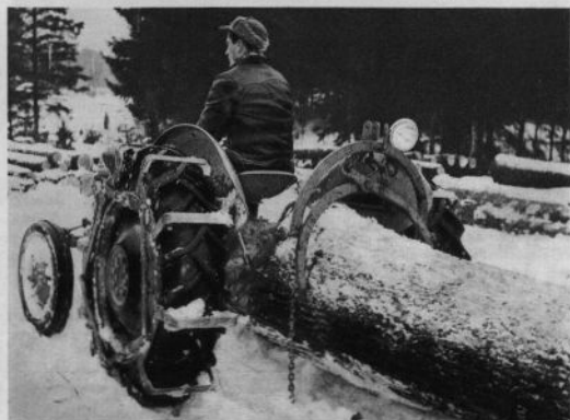
Timmeraxen — ett exempel på det burna redskapets överlägsenhet. Tack vare det hydrauliska systemet kan en del av lastens tyngd överflyttas på traktorn, som därigenom får bättre fäste i väglaget.
