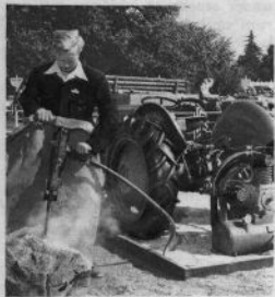
På S:t Eriksmässan demonstrerades en intressant nyhet - ett specialkonstruerat kompressoraggregat för anslutning till Ferguson-traktorns kraftuttag.
