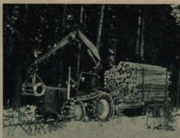
Ett dagligt medeltal av 80 m 3 sk med en drivningslängd av cirka 1 km är ett mycket bra resultat.
