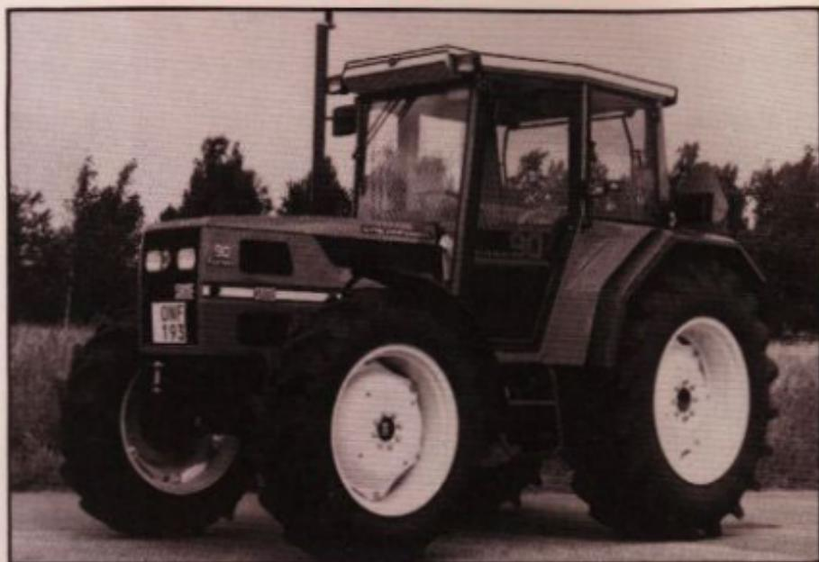
*Störst i Explorer-serien är Explorer 90 II, en lätt, effektiv, nästan underhållsfri traktor i 90-hästsklassen med 4-cyl. turboladdad SAME-motor. Som övriga SAMEs motorer är den olje-luftkyld, vilken dels är unik i sin uppbyggnad, men även är unik i faktumet att det är enda traktormotorn på marknaden i den storleksklassen som nykonstruerats på 80-talet.*
