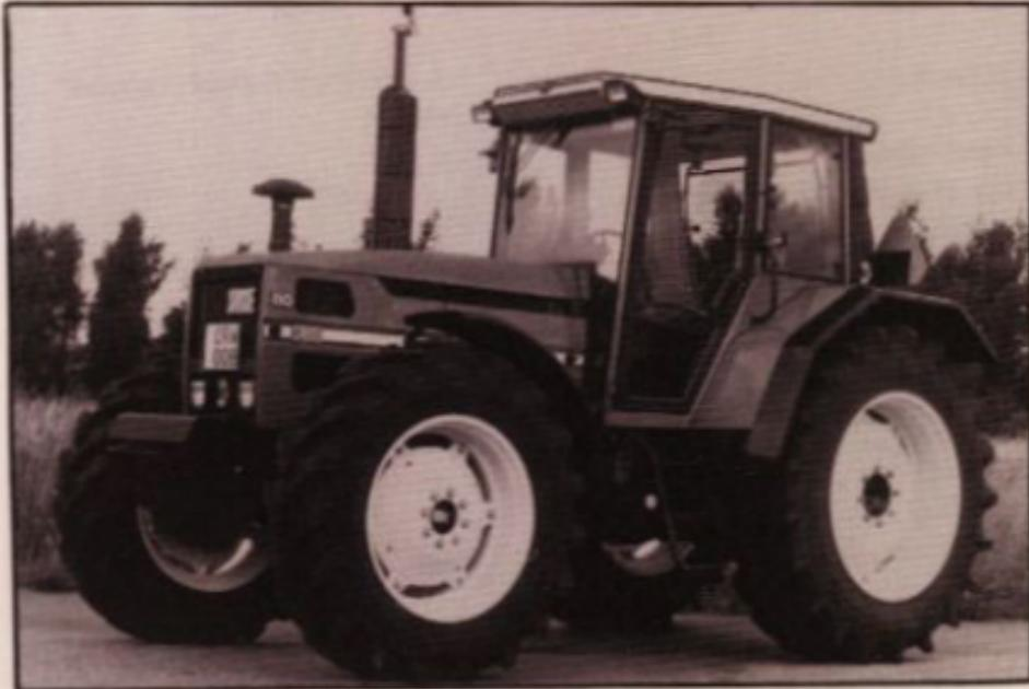
Detta är SAMEs minsta 6-cylindriga modell, med allt vad fördelar betyder med en 6-cylindrig motor. Den vibrationsfria gången, den råstarka segdragningsförmågan, det minimala underhållet och långa livslängden, har gjort SAMEs sexor världsberömda. Hyttens komfort är briljant, med luftkonditionering som standard, med en bullernivå på endast 77 dB, med bekväma reglage — kort sagt du vilar och mår bra samtidigt som du är toppeffektiv i ditt arbete.
