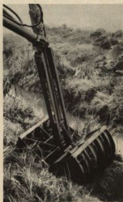
Teckningen till vänster visar Atlas lastaren i gödsellastningsarbete och fotot till höger visar hur Atlas kan utrustas och utnyttjas för t. ex. rensning av diken.
