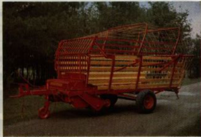
Lastkapaciteten på en Ladeblitz med delad kaross är ung. 1,5 m 3 större än hos en lastare med enkel konstruktion. Baklämmskorgens låsning upphävs med en fotpedal.
