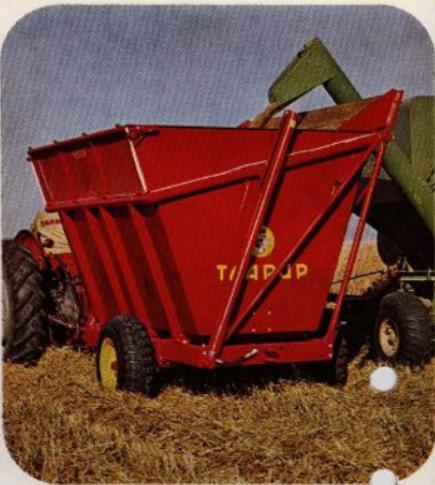
TAARUP T3 tippvagn är helt oumbärlig under skördeperioden. Skördefröska och tippvagn är en kombination, som sparar mycket tid under den intensiva skördesäsongen. Med sidolämmar typ 1, som visas på bilden, rymmer vagnen ca 45 hl spannmål. Den helsvetsade vagnkorgen är fullkomligt tät och således undviks spill helt.
