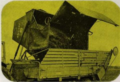
TAARUP T3 tippvagn med sidolämmar typ 2 A i kombination med självlästående vagn är ett lämpligt alternativ för fyllning av silos.
