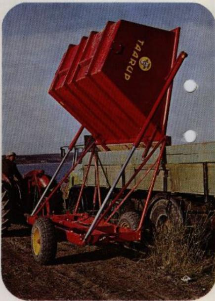
TAARUP T3 tippvagn tippar på 2 m höjd med hjälp av två långa, kraftiga hydraulcylindrar. Vagnen är dessutom försedd med hydraulreglerat stödhjul.
