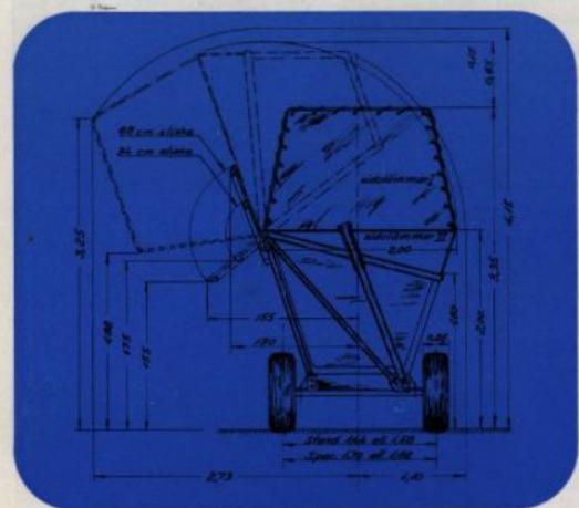
TAARUP T3 tippvagn är utrustad med stödfot – reglerbar från traktorns hydrauliken. Dessa spindlar kan erhållas som extrautrustning. – Som standard levereras vagnen med dragöglor, men kan även erhållas med gaffeldrag.
