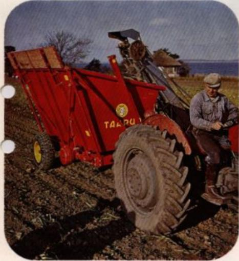
Vid betupptagning utmärker sig TAARUP T 3 tippvagn som den idealiska vagnen. Avlastningshöjden på 2 m lämpar sig väl för betor. Med den påmonterade slischen går det snabbt och enkelt att lasta i järnvägvagn eller lastbil.
