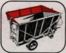
Med sidolömmar typ 1 blir vagnens övre kont vägrät och rymmer då ca 5 m<sup>3</sup>. Tätningslistor garanterar, att skärven mellan vagn och sidolömmar blir helt tät.
