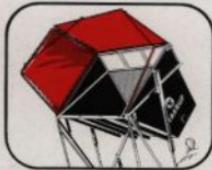
Med sidolömmar typ 2, som består av en rörkonstruktion med fastspänd segeleduk, rymmer vagnen ca 8,5 m<sup>3</sup>. Denne utrustning användes för grönfoder.
