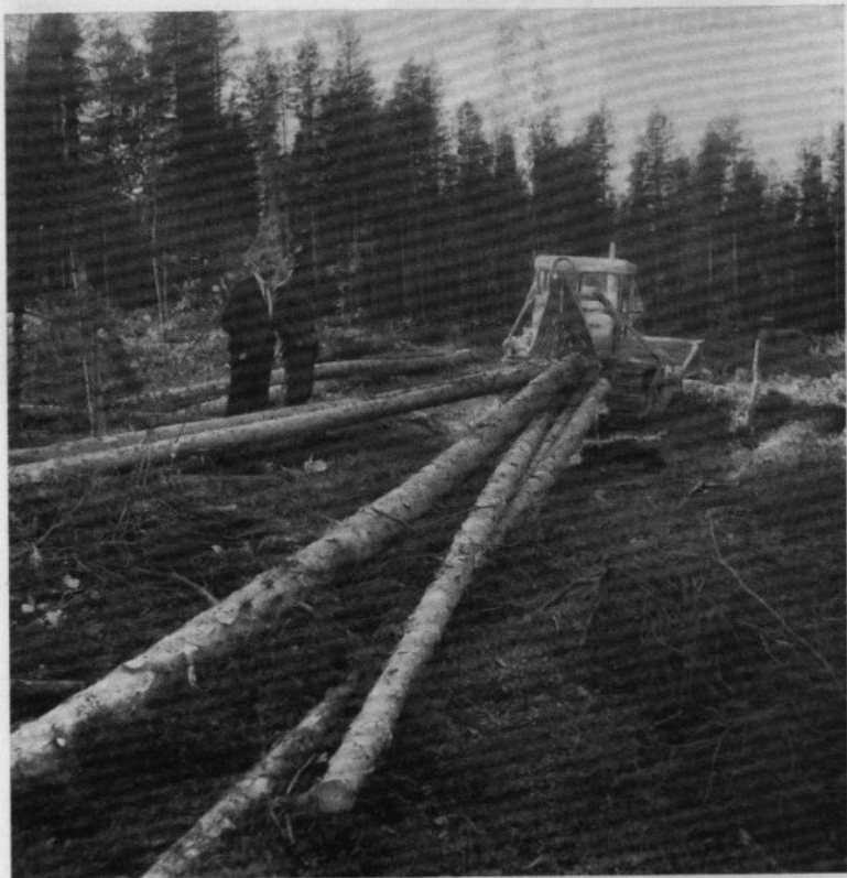
Försöksdrivning på Svanö AB:s Haradsrevir. Här använder man en standard Caterpillar D 4, som försetts med utrusning för att samla bop och bogsera hela stammar till avlägget där stammarna läggs ihop till vältor med hjälp av scbaktbladet.
