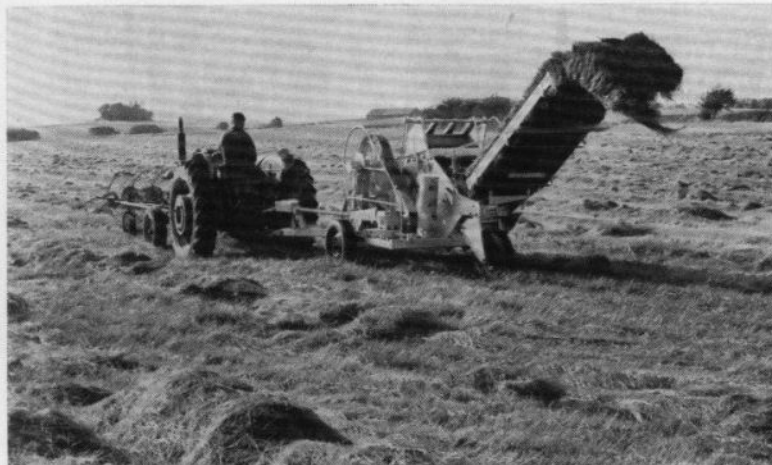
Melichar RC NRA 2-075 kombinerade hård- och löspress i arbete med halmpressning.
