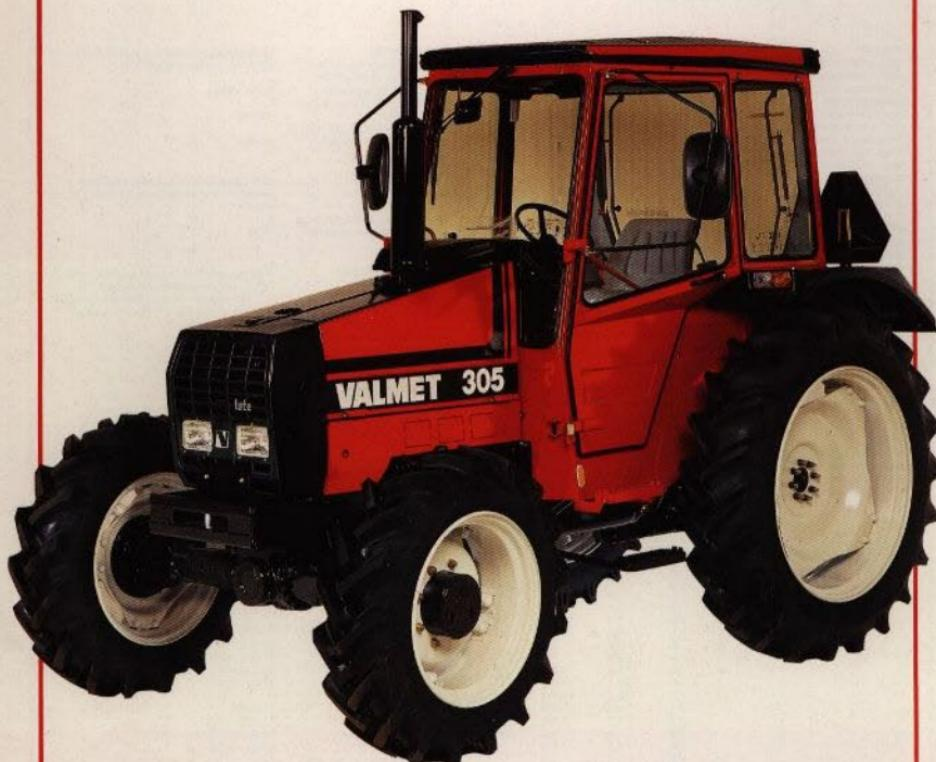
Valmet 305 har egenskaper och en storlek som passar bra för de mindre gårdarnas behov. Genom den totalsynkroniserade växellådan och hydrostatiska styrningen är 305 särledes lättkörd och smidig. Och den turboladdade motorn på 39 kW (53 hk) DIN har styrka och segdragningsförmåga för att klara av arbetet på ett snabbt och effektivt sätt. Den vägplanerade förarhytten är bekväm och säker och erbjuder föaren en god komfort som gör att även de långa arbetsdagarna känns mindre tröttande.
