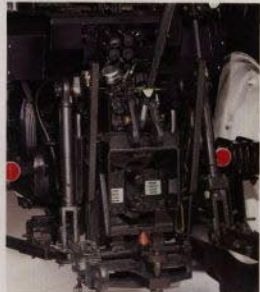
Väl utbyggd yttre hydraulik med upp till 6 olika ventiler och rejäl lyftkraft i redskapslyften ger Valmet-traktorerna stor mångsidighet vid redskapsanvändningen.
