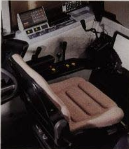
Valmet-modellerna 505 – 905 har som standard en förarsits som kan svängas 180°. Alternativt kan dessa modeller levereras med en helt vändbar förarplats i tre olika utföranden.
