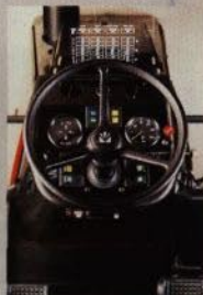
Instrumenteringen är överskådlig med kontrollampor för de olika funktionerna.
