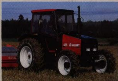
Valmet 455 är den största av dessa tre modeller. Den har en tre-cylindrig turboladdad 3.3 liters motor på 49 kW (67 hk).
