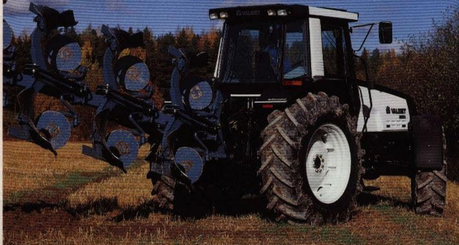
Lyfts snabbkopplingar på dragstänger och foppling är standard liksom tre dubbelstreckade ventiler för yttre hydraulik. Kraftuttaget har hydraulisk inkoppling och belastningsavkänning via Autocontrol II.
