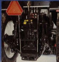
Lyfts snabbkopplingar på dragstänger och foppling är standard liksom tre dubbelstreckade ventiler för yttre hydraulik. Kraftuttaget har hydraulisk inkoppling och belastningsavkänning via Autocontrol II.
