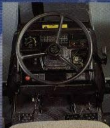
Styret har ställbar lutning och kan även justeras teleskopiskt för en bekväm körställning. Instrumenteringen är tydlig och lättläst.
