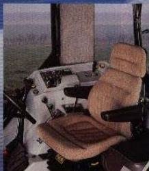
Manöverpanelen för Autocontrol II är bekvämt placerad till höger om förarsätet liksom växelspakarna och spakarna för hydrauliken.
