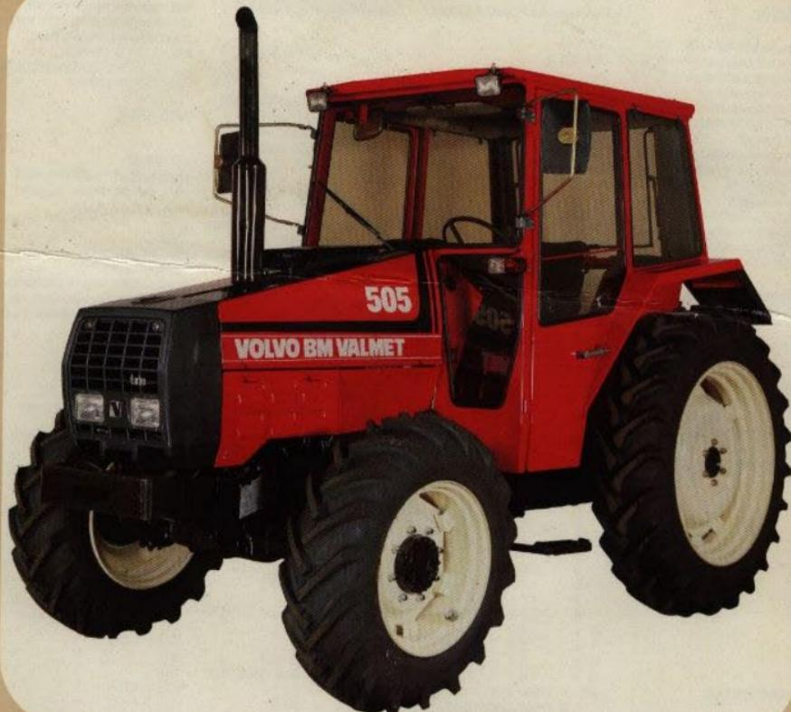
Tekniskt avancerad, smidig och lättkörd – det är Volvo BM Valmet 505. Den extremt segdragande 3-cylindrige turbomotorn på 48 kW (65 hk) gör Volvo BM Valmet 505 till en råstark dragare som inte tappar orken när det tar emot.
