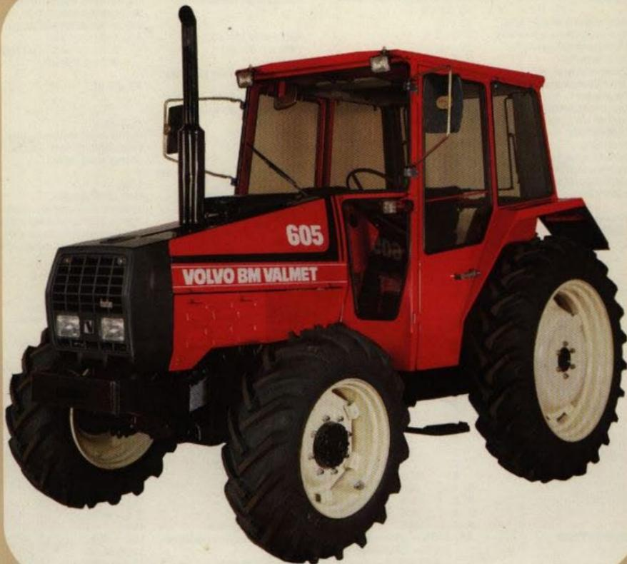
Volvo BM Valmet 605 – en traktor som smidigt klarar krävande jobb på ett effektivt sätt. Turboladdad, bränslesnål 3-cylindrig motor på 53 kW (72 hk), totalsynkroniserad, välvstegad växellåda, väl avvägd viktfordelning och fyrfjulstrift – det är något av styrkan med Volvo BM Valmet 605. Här finns också mångsidigheten genom en riktig anpassning till olika slags redskap – hydraulburna, kraftuttagsdrivna eller frontmonterade – som gör Volvo BM Valmet 605 till en verklig allroundtraktör.
