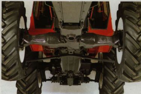
Styrcylindern och dess kolvstång är väl skyddade bakom framaxeln. Också hydraulslangarna för den hydrostatiska styrningen är helt skyddade av chassit och framaxeln.
