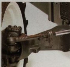
Styrcylindern och dess kolvstång är väl skyddade bakom framaxeln. Också hydraulslangarna för den hydrostatiska styrningen är helt skyddade av chassit och framaxeln.
