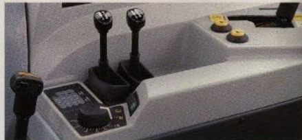
Med ratten sker inställning av önskad arbets höjd för redskapet. Höjning och sänkning av redskapet sker sedan med vippströmbrytare på panelen. Manövrering av lyften kan även ske utanför hytten genom tryckknappar placerade på bakskärmarna. Ventilerna för den yttre hydrauliken manövreras med de båda spakarna i panelen.
