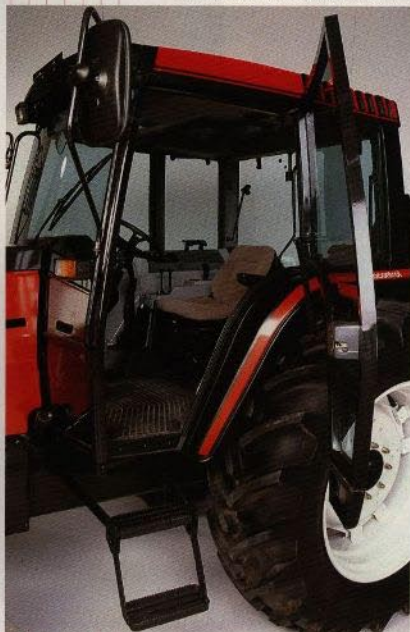
Det går lätt och bekvämt att komma in och ut ur hytten från båda sidor tack vare dörrarnas stora öppningsvinkel, de rejäla, halkfria fotstegen och de extra handtagen som är placerade vid dörrarna. Det nedersta fotsteget är uppfällbart - en praktiskt detalj vid körning i skogen. Påfyllningen av bränsle sker i bekväm höjd.
