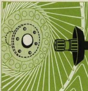
Fingerhjulen är försedda med nållager
