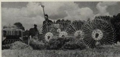
Högerläggande modell i arbete tillsammans med pick-uppress. Råfsan monteras enkelt d. v. s. inga verktyg behövs.
