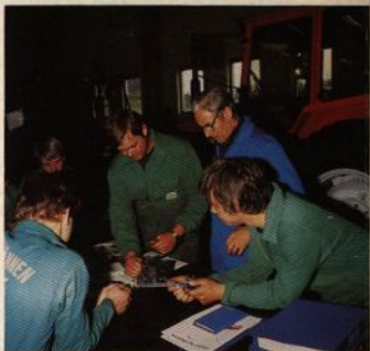
Här provar grabbarna på att göra inställning av ventilsliden för reglerventilen till hydrauliska lyften.
