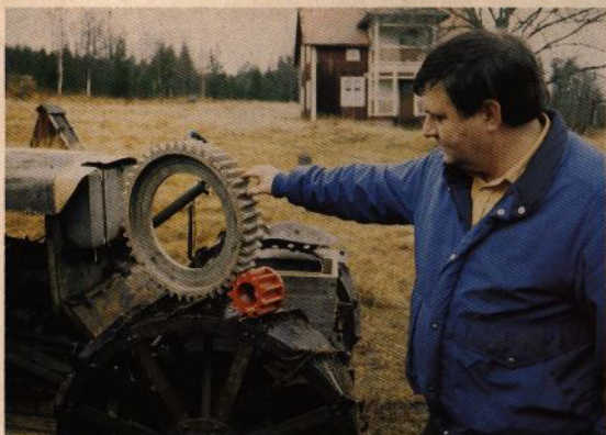
Här är de gjutmodeller av trä som användes för att tillverka nervväxlingsreven i bakhjulen
