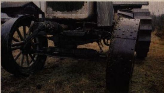
Framaxelfjädringen består av ett tvärställt bladfjäderpaket
