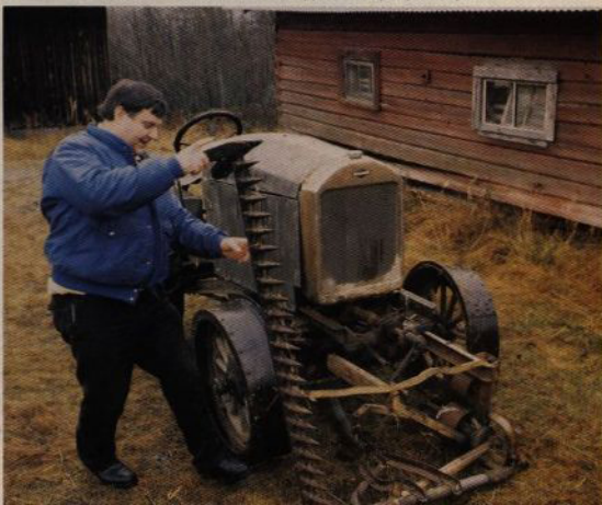
Den frontmonterade slätterkniven kunde fällas upp med en spak på förarplatsen
