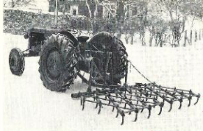
För styva jordar — krokpinharv. Här hydraulburen i två aktioner.
