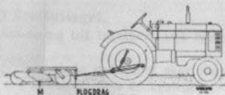
Bild 9. Dragbommens inställning — bogserad plog.
