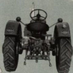
Lyften monteras på växel-lådans bakgavel, medan oljepumpen placeras i direkt anslutning till motorn.
