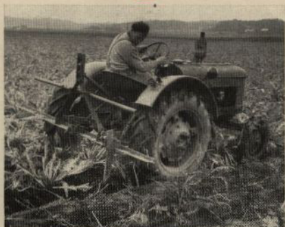
Så här skördas pepparrotten på traktorvis. Den av Gustav Johanssons specialkonstruerade kniven befriar pepparrotstockarna från rötterna hur effektivt som helst.
