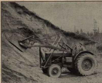
En T 55:a med spetskopa: Skopan har fyllts och håller på att höjas
