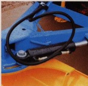
Tillbehör: hydraulisk svängning av bladet
