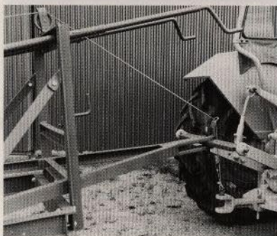
Vägsladden ansluts till traktorn med en tvärbom mellan lyft-armarna. Vid manuell reglering ansluts wiren som lyfter strängspridaren till traktorns Jordbruksdrag.
