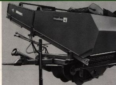
Elevatortanken rymmer 1700 l. Den kan tömmas med utloppet inställbart mellan 1,30—2,50 m över marken. Tanken tömmas (även under körning framåt) med en hel bottenelevator som har rostfria profilister monterade på rullkedjor. Utloppet fälls hydrauliskt helt upp för transport.
