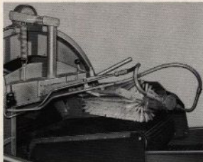
Stenfrånskiljningsaggregat med perlonborste, gummimatta och ventil för steglös varvtalsinställning.
