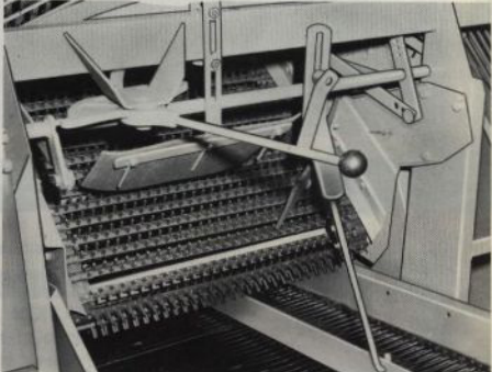
Det ställbara, bakåtgående gummitfingerbandet tar skonsamt emot potatisen från lyfthjulet samtidigt som en efterrensning sker av blastrester, jord och sten.
