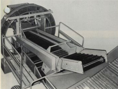
Sorteringsbandet på modell 644 med ställbar bredd på avrenskanalen.
