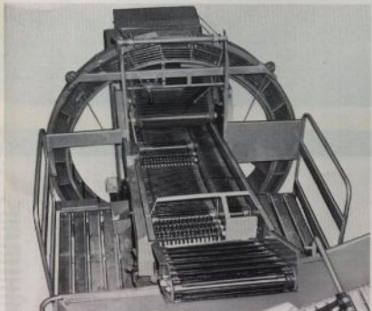
Wühlmaus 644 med tre främre och tre bakre sorteringsvalsar på sorteringsbordet. Säljes ej i Sverige.
