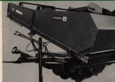
Elevatortanken rymmer 1700 l. Den kan tömmas med utloppet inställbart mellan 1,30—2,50 m över marken. Tanken tömmas (även under körning framåt) med en hel bottenelevator som har rostfria profilister monterade på rullkedjor. Utloppet fälls hydrauliskt helt upp för transport.
