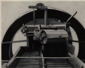
Sorteringsbordet med breda sorterings- och avrensmattor samt stenfrånskiljningsaggregat.
