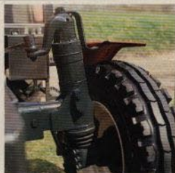
Fjädrande framspindlar spar både traktor och förare!
