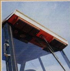
Inbyggt värme- och friskluftsystem i taket — med luftfilter ...
