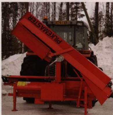
Transportör ovanpå maskinen låses i transportläge.
