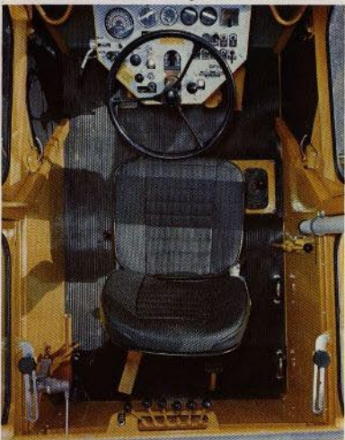
Föraren kan även vänd bakåt köra framåt — dubbla styrsystem.
