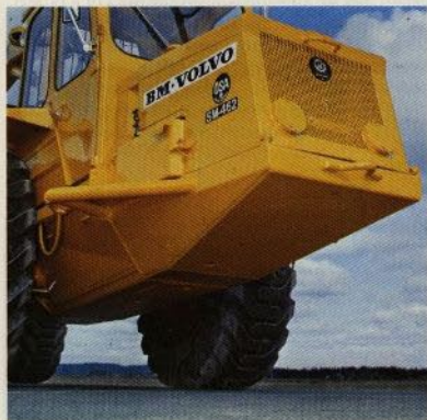
Slät undersida och stor frigångshöjd.
