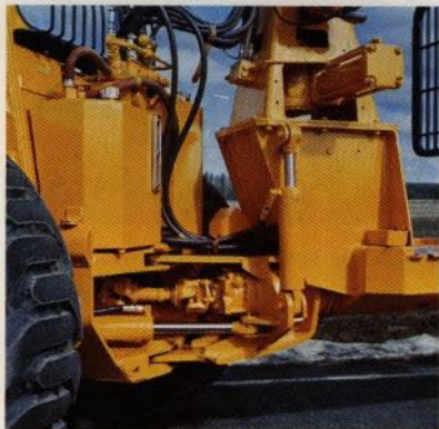
Hydraulisk ramstyrning. Stabiliseringscylinder mot krängningar.
