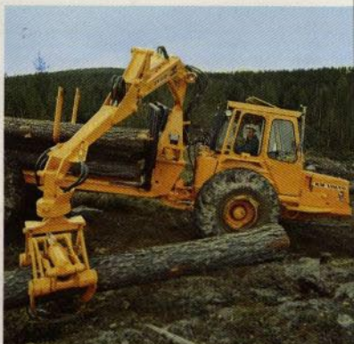
Griplastare med 4,7 m armlängd och 0,25 m 2 griparea.
