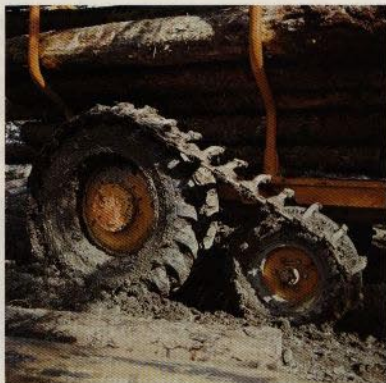
Bandutrustning med ledarhjul och hydraulisk bandspänning.
