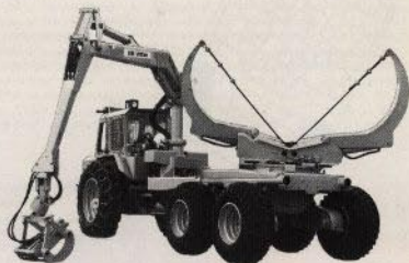
Klämbanken kan monteras av och lunnaren förvandlas då till skotare.
