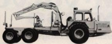
BM-VOLVO SM 868 skotare, försedd med en USA-350 griplastare monterad på lastenheten.
