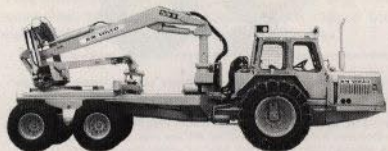
BM-VOLVO SM 868 lunnare, försedd med en OSA-380 griplastare och en OSA 820 klämbanke.
