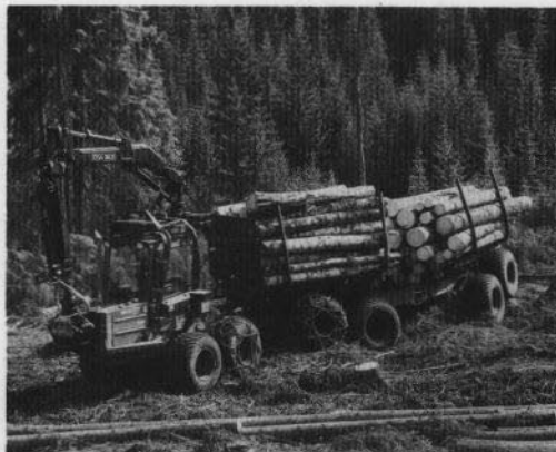
Maskinen utrustad som skotare för transport av rundvirke eller delträd
