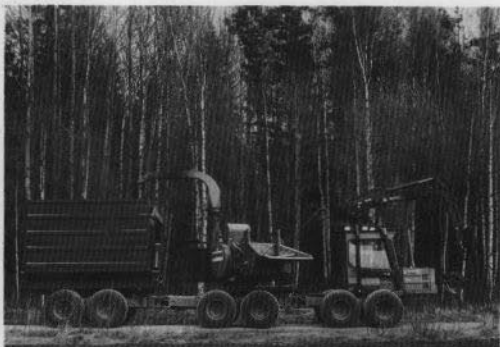
Maskinen utrustad som terränggående flismaskin med Erjo flihhugg som drivs av en Caterpillar motor
