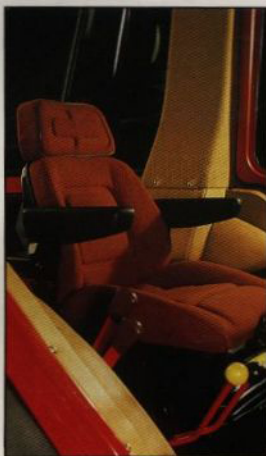
I moderna hytter, som XL-hytterna, finns mycket avancerade stolkonstruktioner. Reglerbara i alla riktningar, stötuftagande och sittkorta.
