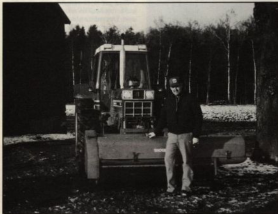
Inspektör Lennart Svensson tillhör dem som börjat tänka "på längden". Med hydraulik i fronten gör den här traktorn dubbelt arbete - blästaggregat fram, betupptagare bak.
