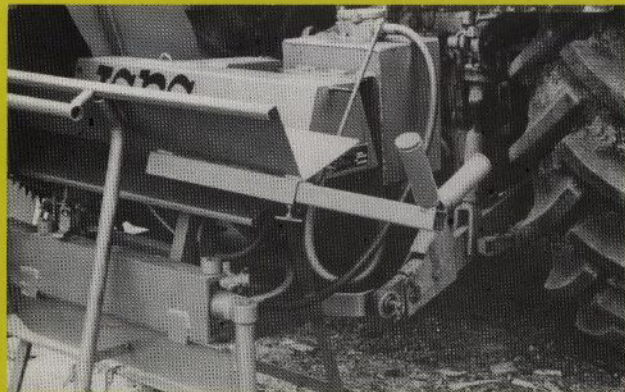
Högra visar den utdragbara stockrullen, som gör det lätt att hantera 3-m bitar.
