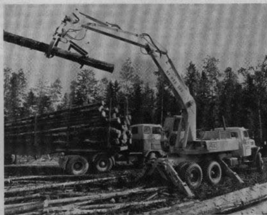
Tedpunktsprincipen med grip och hül ger säker fältning. Föraren slipper att leta efter stammens tyngdpunkt.
