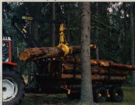
bitehåller lyftkraften i tränga lägen
