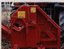
Kap- och klyvmaskinen är också försedd med dragkrok. Både kap/klyvmaskin och släpvagn kan alltså vara kopplade till traktorn samtidigt.
