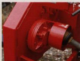
Drivkraften leds via kardanaxeln till en reduktionsväxel, och därifrån vidare till kap- och klyvstället via en kraftig växel och vevstake.
