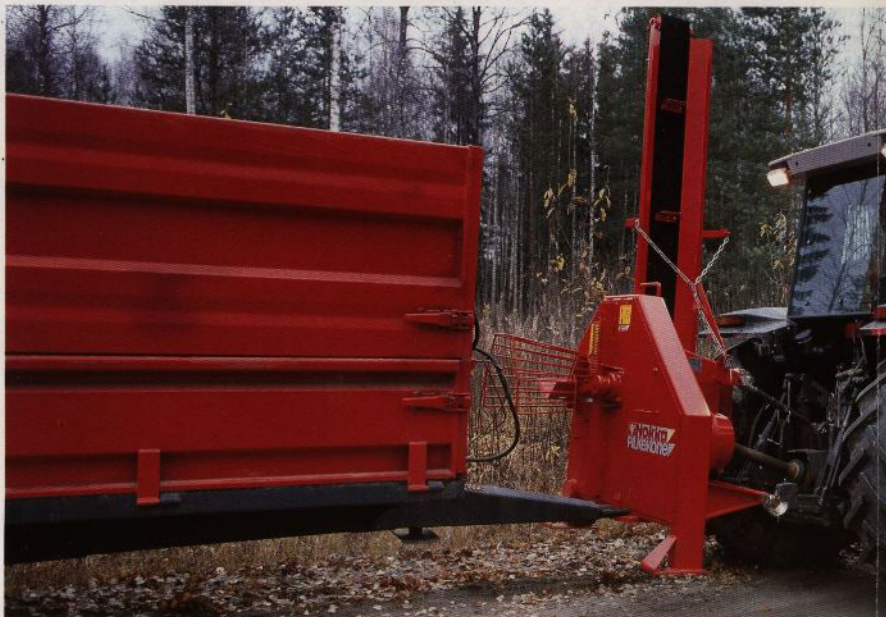
En tre meter lång transportör, som är standard, lastar veden snabbt i släpvagnen efter i vedlagret. Transportörens drivkraft överförs från reduktionsväxeln med två driveckor.
