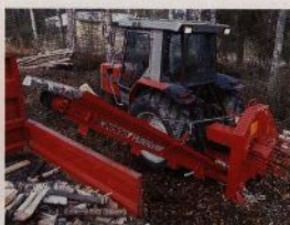
En tre meter lång transportör, som är standard, lastar veden snabbt i släpvagnen efter i vedlagret. Transportörens drivkraft överförs från reduktionsväxeln med två driveckor.
