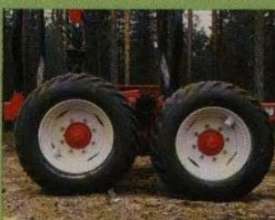
Däckdimensionen hos PATU Allgripen 95 är 400/55 x 22,5/14 ply. Alla fyra hjul är drivande. Drivvullen är till sin konstruktion öppen och är därtill genom självrulleende. Bakhjulen är utrustade med hydrauliska trombromsar.
