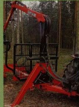
PATU Allgripen 600 eller 750-lastarna kan med hjälp av åsmonteringsdetaljer monteras på 85:ans bom. Härvid är lastaren snöbokkopplad. Övriga monteringsalternativ är: pelarmontering på bom eller bak-axelanpassning.
